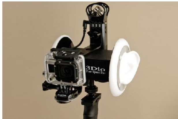
Figure 19 - Le Free Space équipé de l'attache permettant de fixer une caméra (ici une GoPro) ainsi qu'un enregistreur Zoom H1.
